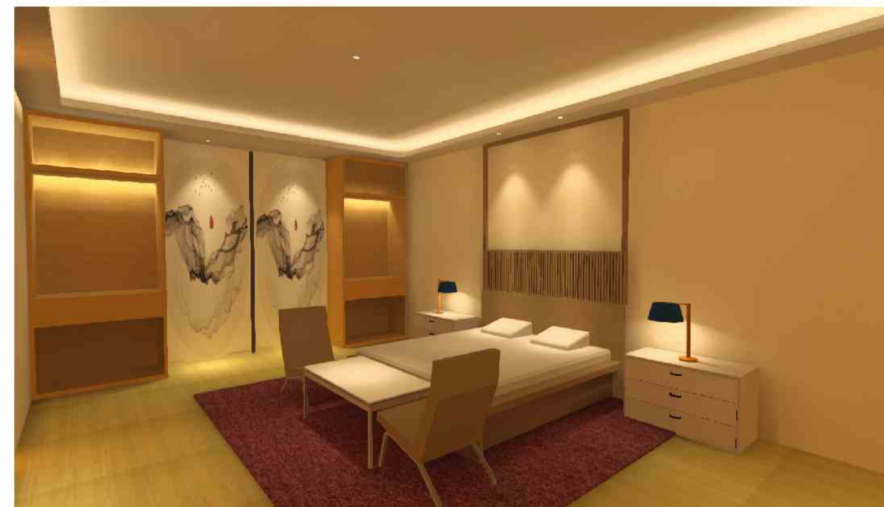
2.8米层高客房模拟图 (灯具参数: 12W, 24°)
