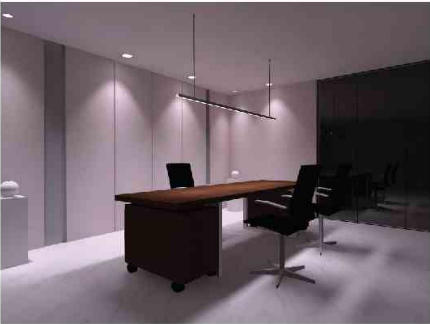
直下式透镜办公室模拟图 (灯具参数:30W, 15°)
