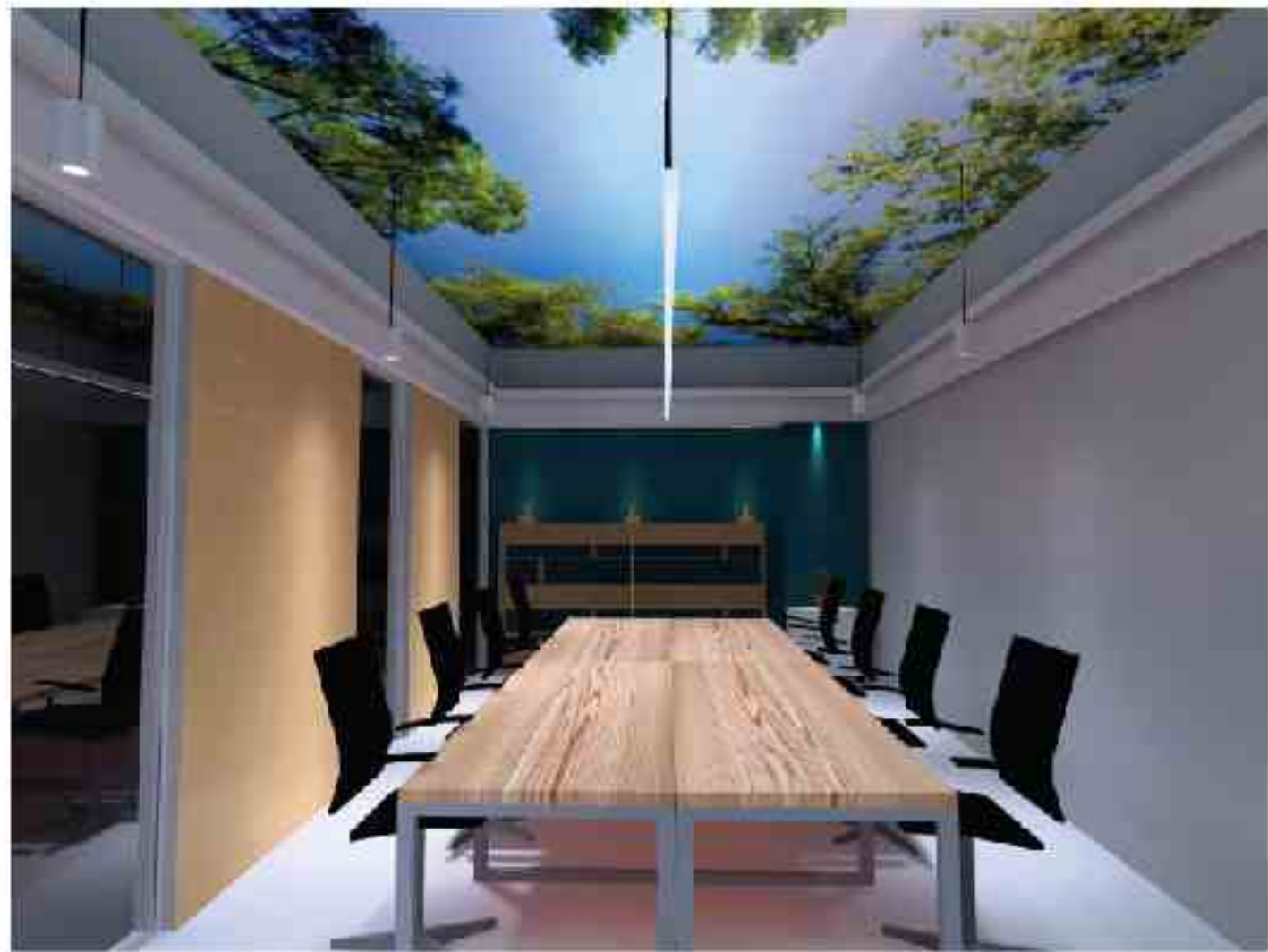
上下发光会议室模拟图 (灯具参数:50W, 120°)
