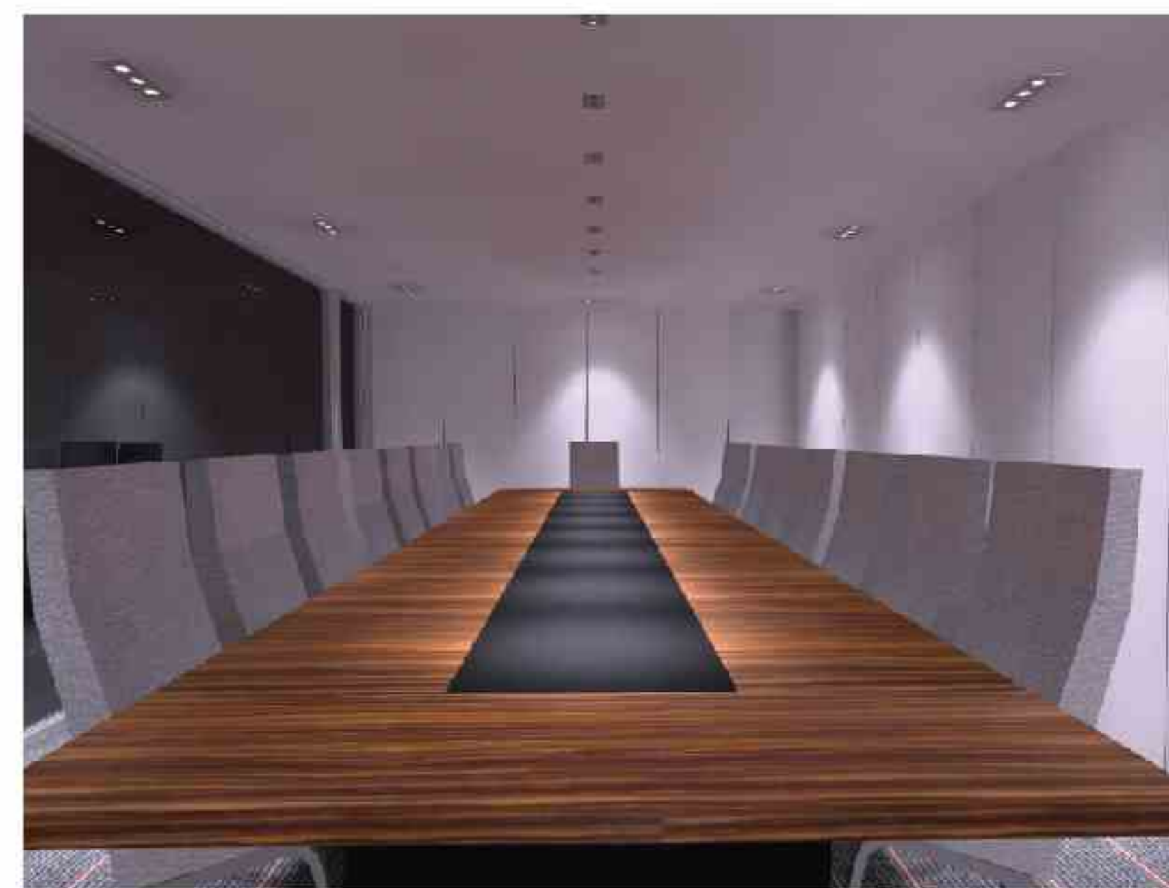
3米层高会议室模拟图 (灯具参数:10W, 12°(会议桌); 30W, 24°(四周墙面))
