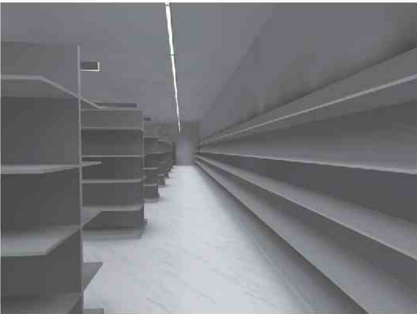
单偏发光货架通道模拟图 (灯具参数:30W, 单偏光)
