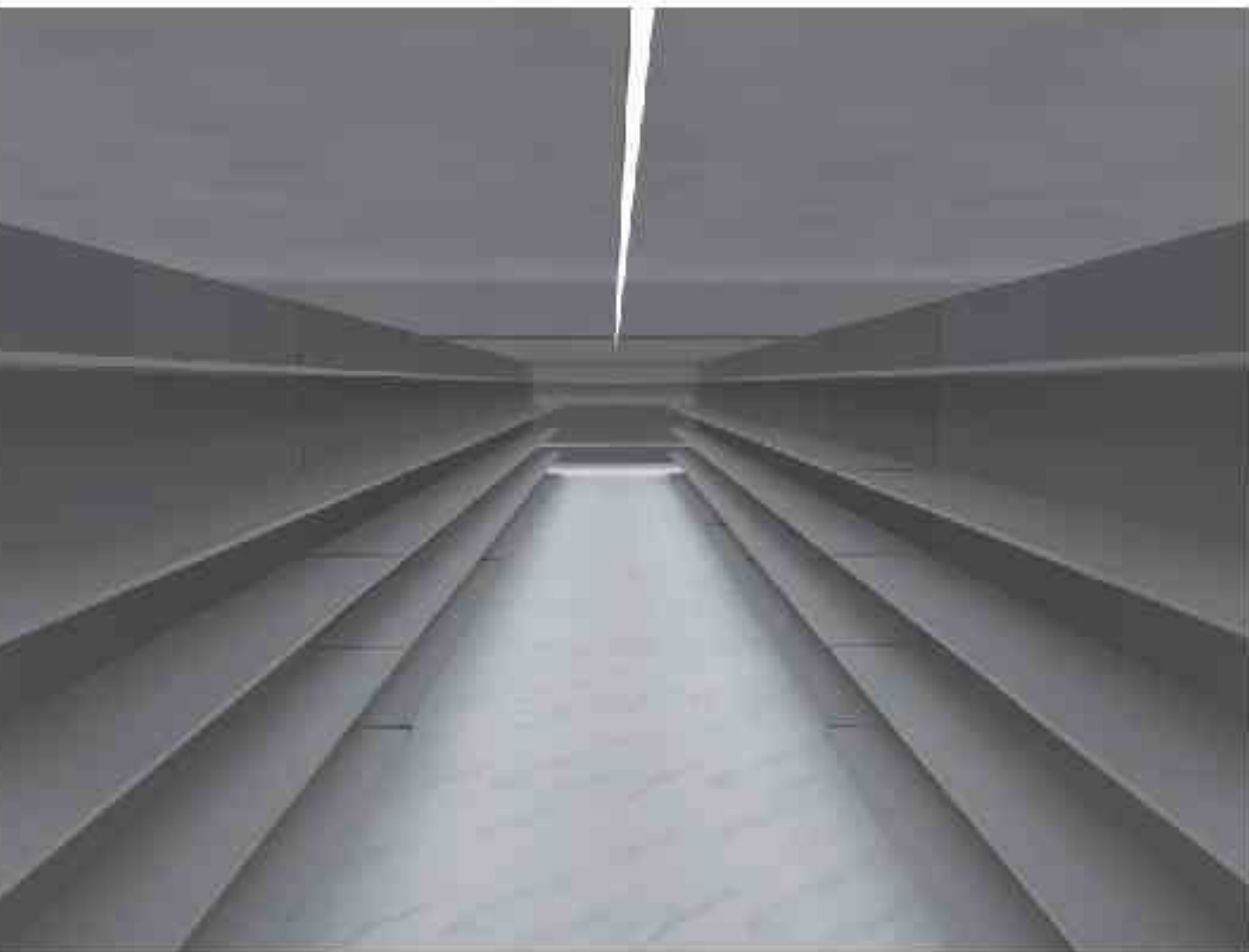
双偏发光货架过道模拟图 (灯具参数:30W, 双偏光)
