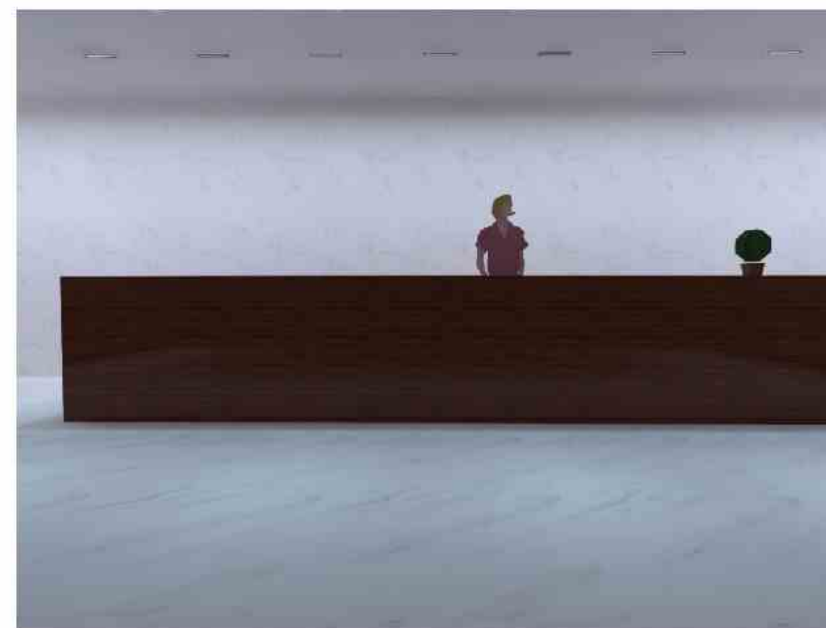
3米层高前台模拟图 (灯具参数:20W, 偏光洗墙)
